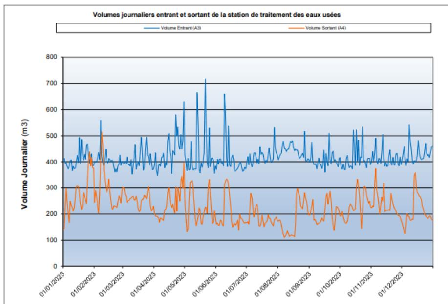
Ecart entrée / sortie important du au double impact du lagunage et du Rockfilter.
