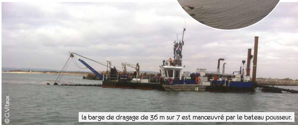
la barge de dragage de 36 m sur 7 est manœuvré par le bateau pousseur.
